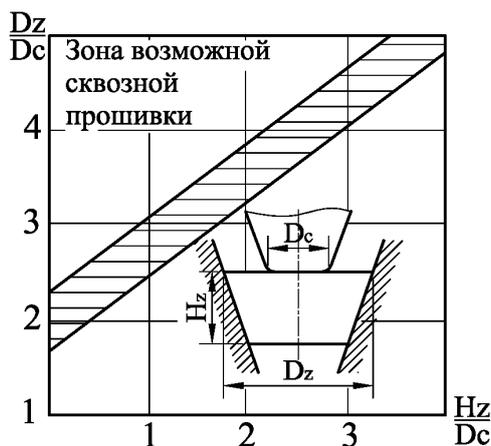
Рис. 1. Выбор размеров для предварительно оформленной заготовки
